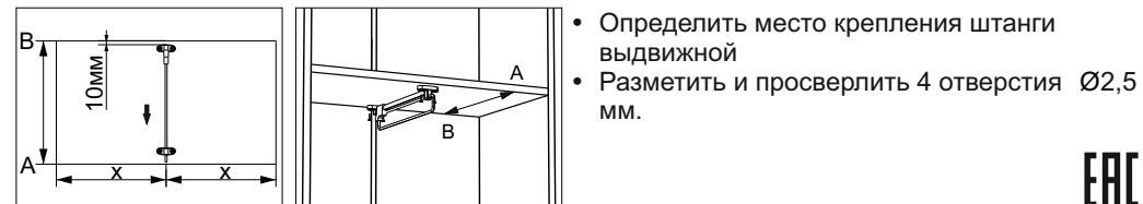
Схема В. Установка штанги выдвижной
