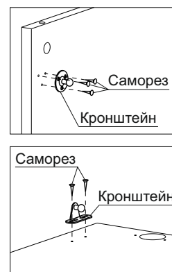
Схема 8. Установка кронштейнов газлифта
