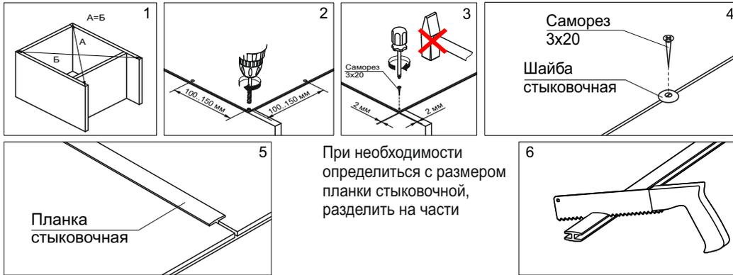
При необходимости определить с размером планки стыковочной, разделить на части
