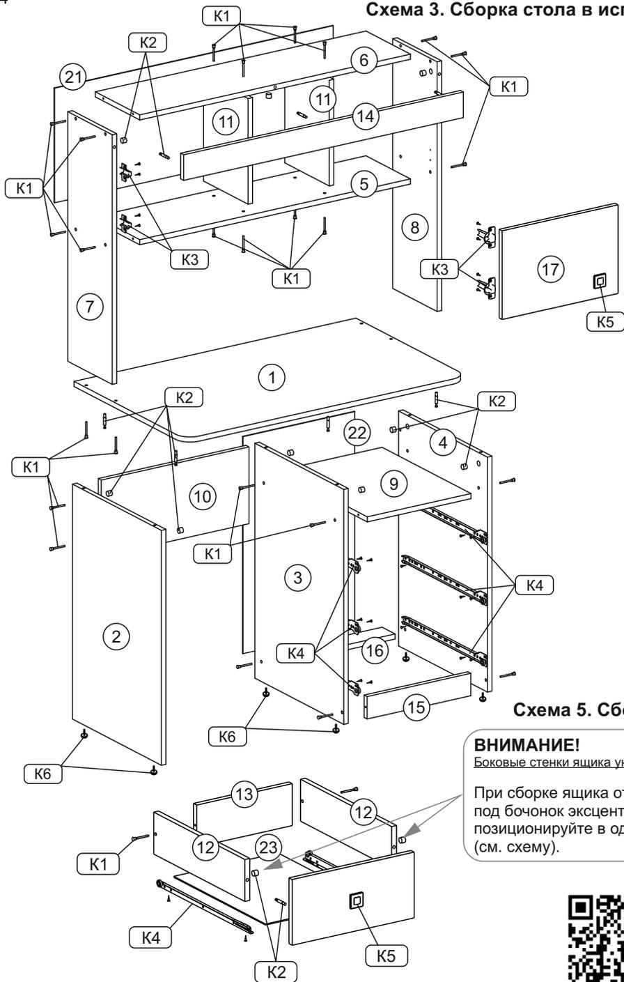
Схема 5. Сборка ящика
